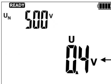
Prüfgerät ist bereit zur Messung.
