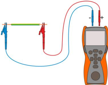
Das Messgerät an das geprüfte Objekt anschließen.
