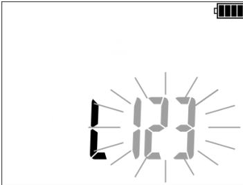
Das Blinken der Ziffern bedeutet keine oder zu geringe Spannung der jeweiligen Phasen.
