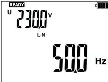
Messergebnis ablesen: die Spannung auf dem Behelfsfeld der Anzeige, die Frequenz auf dem Hauptfeld.
