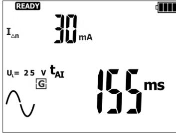
Ansprechzeit t<sub>AI</sub> bei dem Strom I<sub>A</sub>
