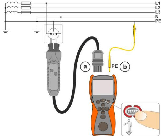
Nach Abschalten des Messgeräts, wie auf der Abbildung, die Berührungselektrode mit dem Finger berühren und ca. 1 Sekunde abwarten. Nach Feststellung der Spannung auf dem **PE** wird auf dem Gerät die Aufschrift **PE** angezeigt (Fehler in der Installation, PE-Leitung angeschlossen an die Phasenleitung) und ein stetiges Tonsignal erzeugt. Diese Möglichkeit ist für alle Messfunktionen, die die RCD-Schalter und Kurzschlusschleifen außer  $Z_{L-N,L-L}$  betreffen, zugänglich.
