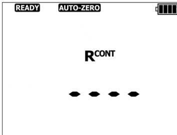
Nach Beendigung der Selbstnullung geht das Messgerät automatisch zum Bildschirm der Messbereitschaft über.
