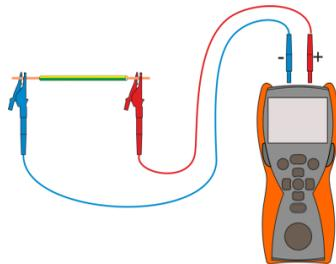
Das Messgerät an das geprüfte Objekt anschließen. Die Messung beginnt automatisch für Widerstände von kleiner als  $100 \Omega$ .
