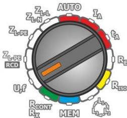
Drehschalter der Funktionswahl in die Position **U<sub>f</sub>** einstellen.
