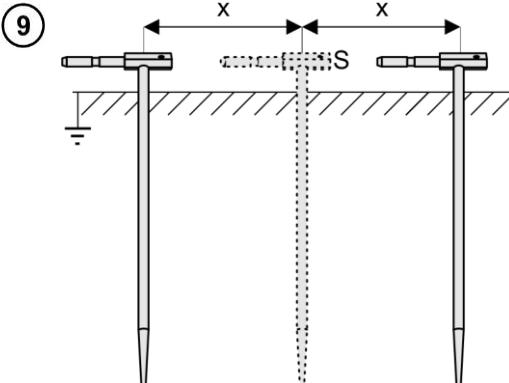
9 Wiederholen Sie die Schritte 4 6 7 an zwei verschiedenen Positionen der Spannungselektrode **S**:
