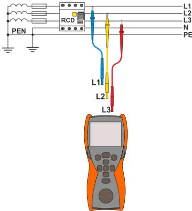
Das Gerät gemäß der Zeichnung an die Installation anschließen.
