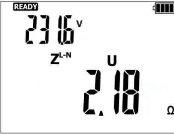
Hauptmessergebnis ablesen: Impedanz der Kurzschlußschleife  $Z_S$  sowie die Netzspannung im Moment der Messung.
