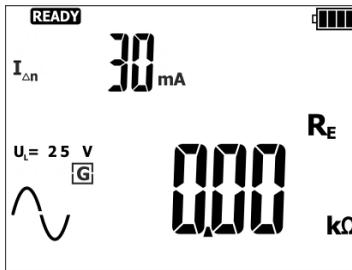
Widerstand des Schutzleiters für RCD –  $R_E$
