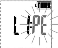
Wenn die Drahtkennzeichnung eingeschaltet (RISO PAIR – Kapitel 2.2), aber der WS-Adapter nicht angeschlossen ist, wählen Sie die erforderlichen Kennzeichnungen aus. Das aktive Element blinkt.
